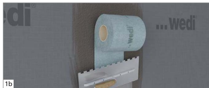
1b Pour les applications en locaux EB+ collectifs, les jonctions et percements peuvent être étanchés alternativement à l'aide de la bande d'étanchéité wedi Tools et de la colle à carrelage de type C2.
