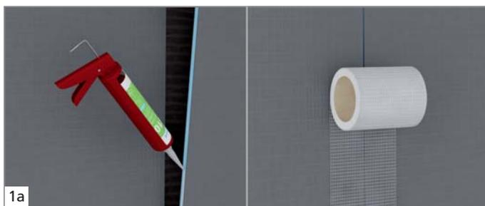
1a Dans les pièces humides, les jonctions peuvent être traitées avec le mastic polymère wedi 610. Ensuite, il faut poser la bande d'armature autocollante wedi Tools à chaque jonction de panneau.
