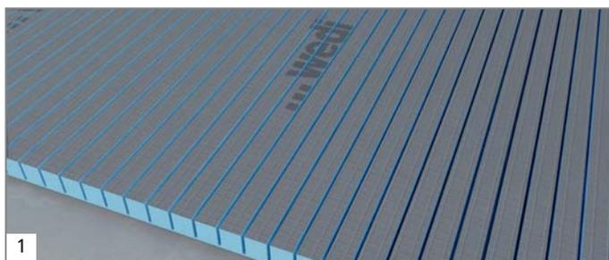
1 Le panneau de construction wedi Construct prédécoupé existe en version longitudinale et en version transversale. Avant sa mise en forme, les stries du panneau doivent être remplies avec une colle à carrelage de type C2, afin de rigidifier le panneau.
